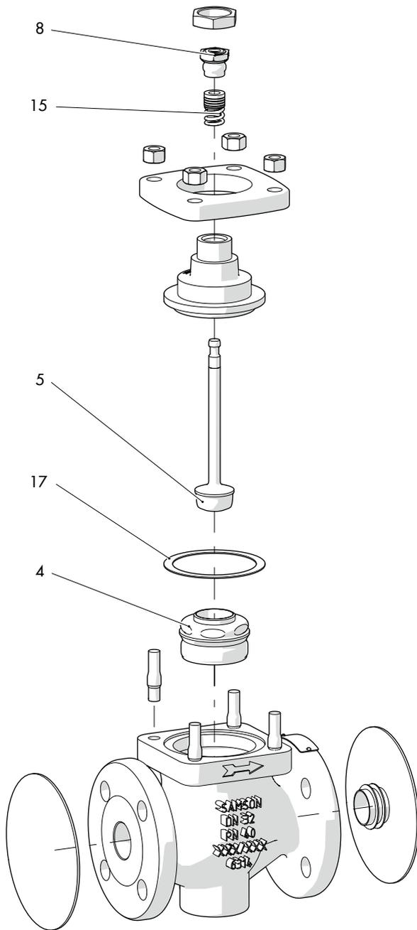
**Bild 2:** Mitgelieferte Ersatzteile
