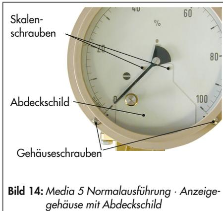
**Bild 14:** Media 5 Normalausführung · Anzeigengehäuse mit Abdeckschild
