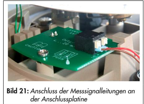
Bild 21: Anschluss der Messsignalleitungen an der Anschlussplatine
