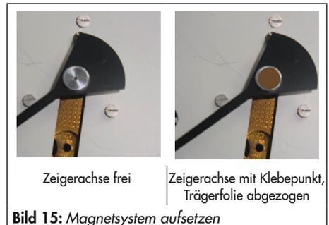
**Bild 15:** Magnetsystem aufsetzen
