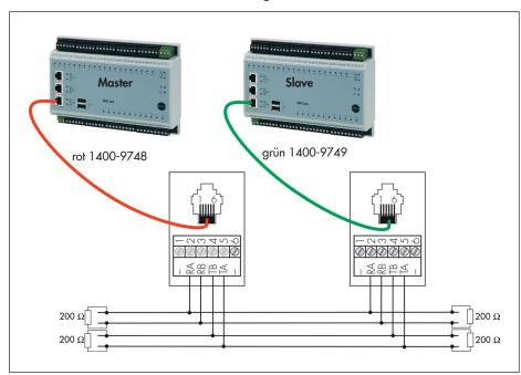
Modbus-Masterfunktion mit einem CPU-Modul TROVIS 6610 und einem Regler TROVIS 55xx als Slave und einem CPU-Modul TROVIS 6610 als Master in Zweileiter-Anschaltung.
