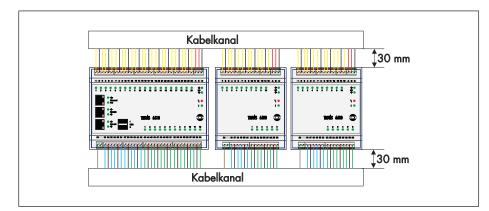
Mindestabstand zwischen Modulen und Kabelkanal
