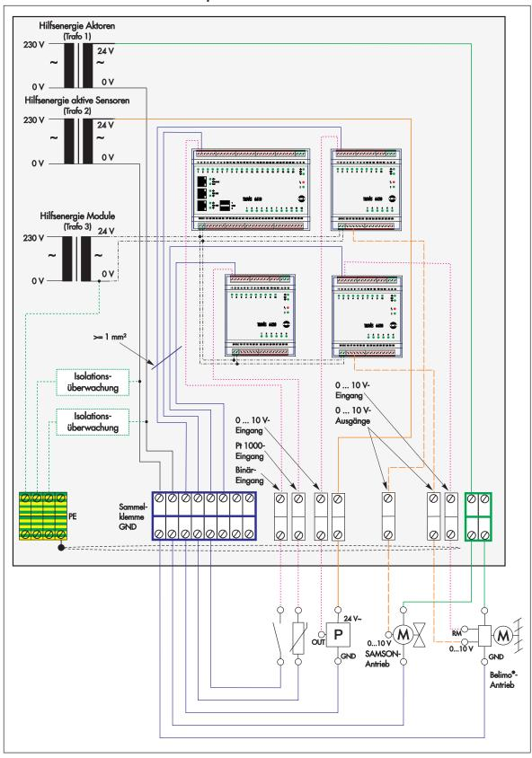
Installationsbeispiel 1: Passive und aktive Sensoren sowie Aktoren
