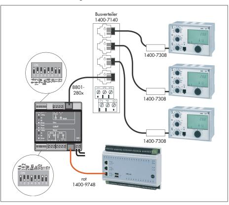
Modbus-Masterfunktion mit Zählerbus-Modbus Gateway.
