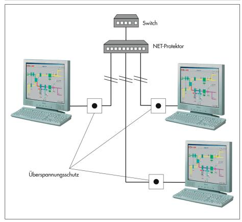
Maximalschutz für Twisted-Pair-Verkabelung
