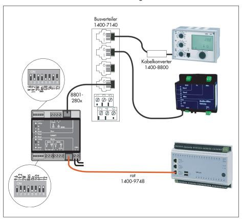
Modbus-Masterfunktion mit dem Modul BZK1000MOD von Romutec<sup>®</sup> Auch in diesem Beispiel muss eine Brücke am Einfach-Busverteiler zwischen RA/TA und RB/TB vorgesehen werden.
