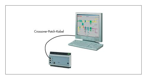
In dem dargestellten Netzwerk aus CPU-Modul TROVIS 6610 und PC ist es nicht möglich einen weiteren Netzwerkteilnehmer hinzuzufügen. Eine Erweiterung des Netzes ist nur mit Hilfe von Zusatzgeräten, z. B. eines Switch möglich.
