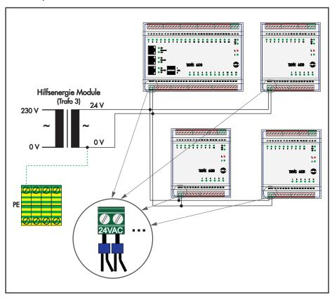
Verdrahten der Hilfsenergie der Module
