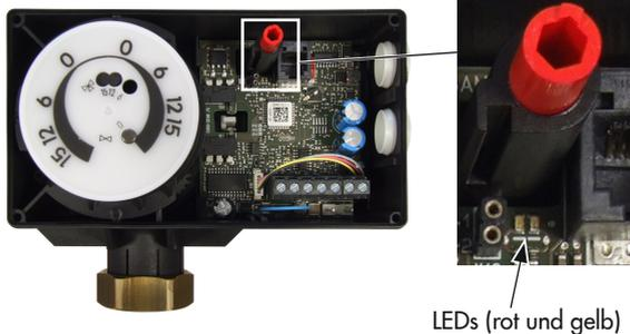
Bild 16-2: Position der LEDs bei Ausführung 24 V
