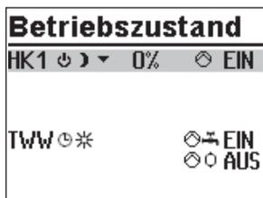
Drehesalter auf die Schalterstellung „Betriebsarten“ drehen. Es werden die Betriebszustände aller Anlagen-Regelkreise angezeigt:
