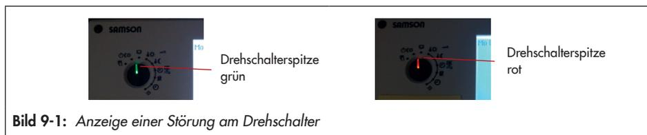
**Bild 9-1:** Anzeige einer Störung am Drehschalter
