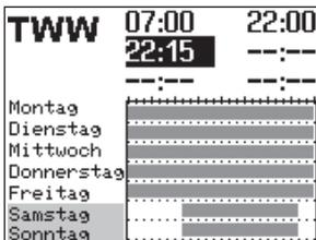
Zum Einstellen des zweiten und dritten Nutzungszeitraums die grau hinterlegten Schritte wiederholen. Sollen keine weiteren Nutzungszeiten für den gewählten Zeitraum/Tag eingestellt werden, wird das Menü durch zweimaliges Bestätigen der angezeigten Startzeit beendet (2x \*).
