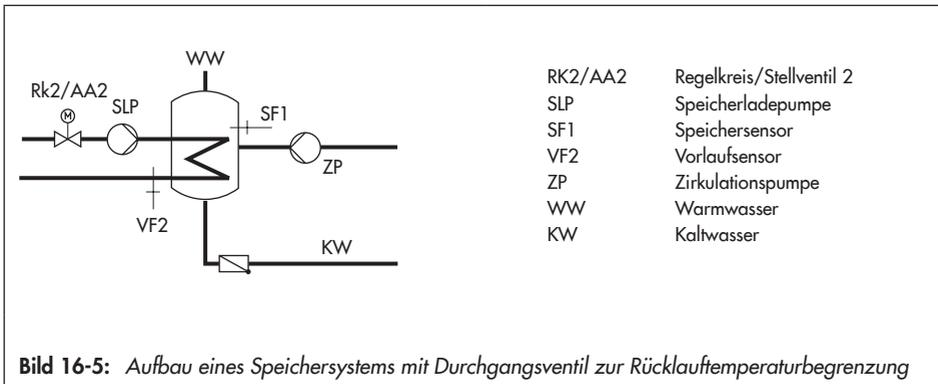
Durchgangsventil und Temperatursensor VF2 dienen in der oben dargestellten Schaltungsvariante ausschließlich der Rücklauftemperaturbegrenzung. Der Vorregelkreis stellt wie in der Standard-Schaltung mindestens eine Vorlauftemperatur zur Verfügung, die sich aus 'Sollwert Trinkwasser' + 'Überhöhung Ladetemperatur' + 'Überhöhung Sollwert Vorregelkreis' ergibt.
