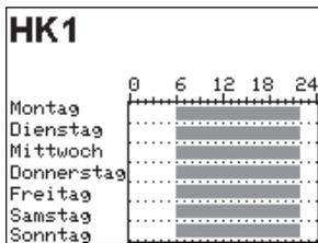
Dreheswitcher auf die Schalterstellung „Nutzungszeiten“ drehen. Der erste Regelkreis wird zusammen mit den aktuellen Nutzungszeiten angezeigt.
