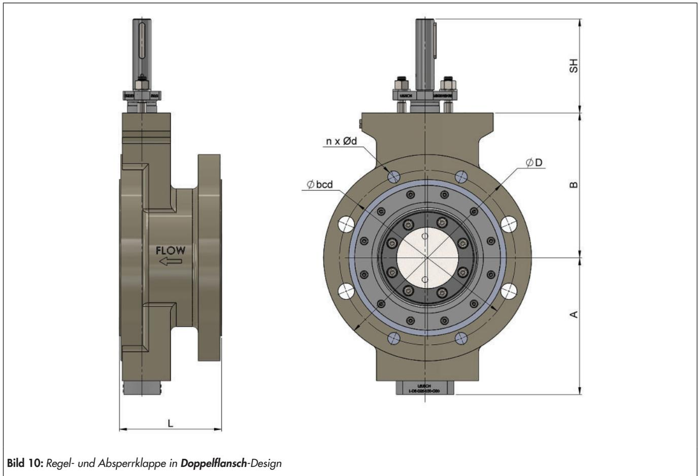
Bild 10: Regel- und Absperrklappe in Doppelflansch-Design
