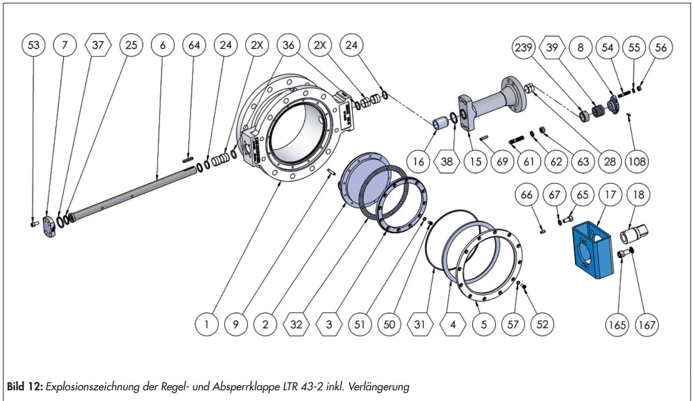
**Bild 12:** Explosionszeichnung der Regel- und Absperrklappe LTR 43-2 inkl. Verlängerung
