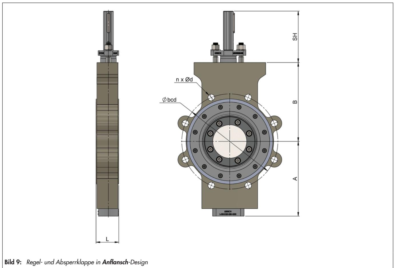
Bild 9: Regel- und Absperrklappe in Anflansch-Design
