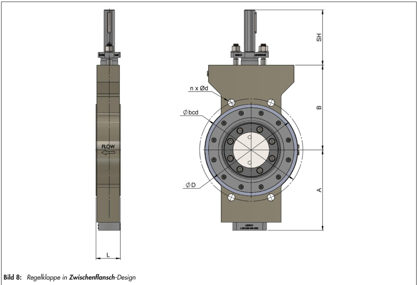
Bild 8: Regelklappe in Zwischenflansch-Design
