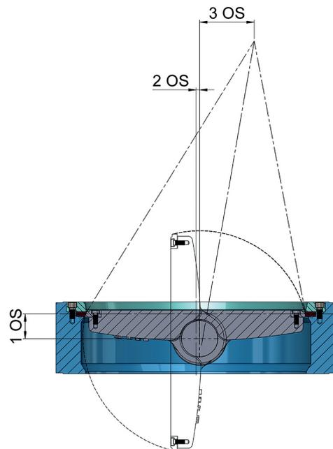
Bild 3: Dreifach-Exzentrizität
