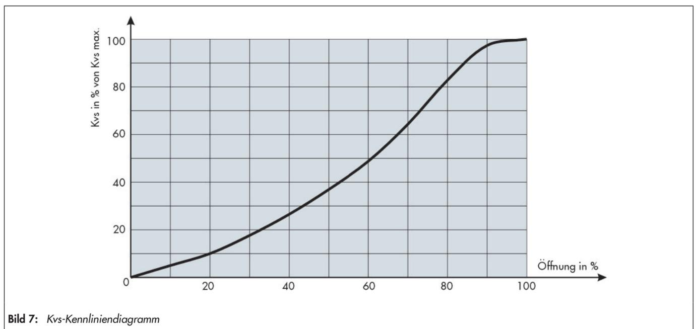
**Bild 7: Kvs-Kennliniendiagramm**
