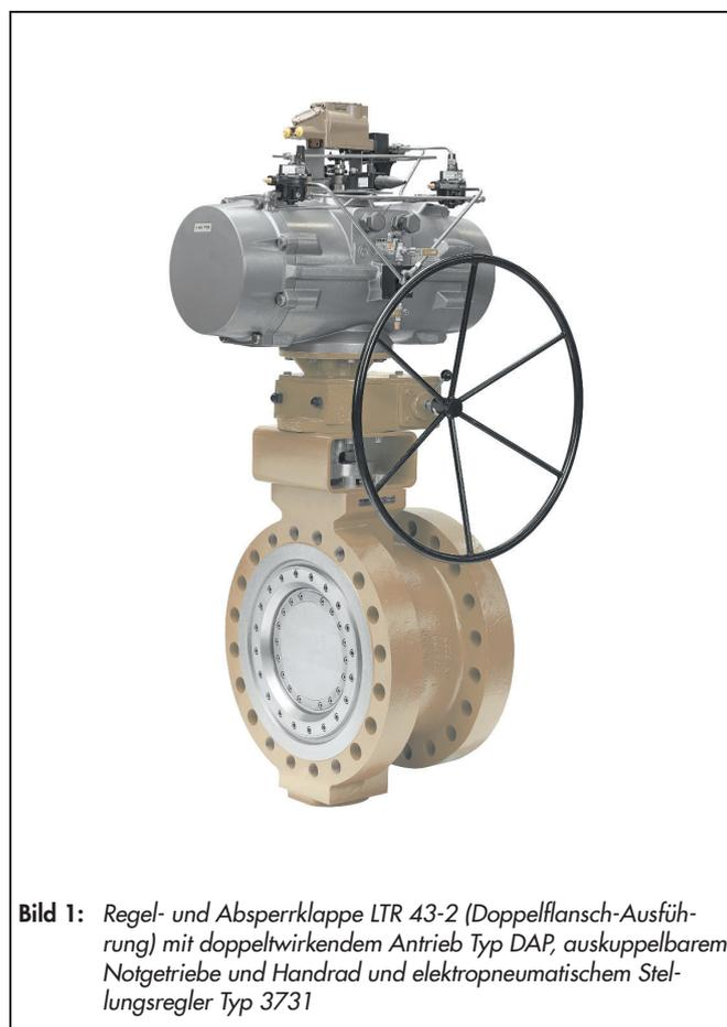
**Bild 1:** Regel- und Absperrklappe LTR 43-2 (Doppelflansch-Ausführung) mit doppelwirkendem Antrieb Typ DAP, auskuppelbarem Notgetriebe und Handrad und elektropneumatischem Stellungsregler Typ 3731
